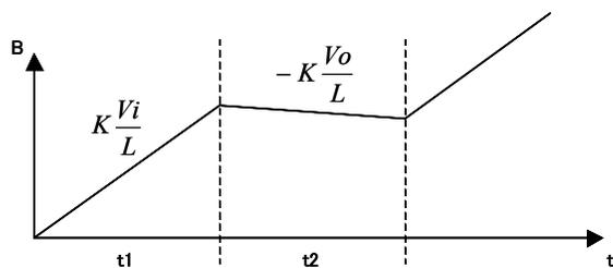
磁気飽和を起こさない最大の入力期間  $t_1$  は、出力電圧  $V_o$  によって決定されます。これを精密に計算すると CPU 時間を消費するため、PWM 設定処理の中で簡易的にテーブルルックアップを行って対処しています。
